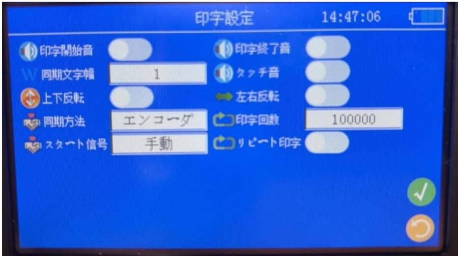
**印字開始音**: 印字時開始時の ON と OFF 設定
